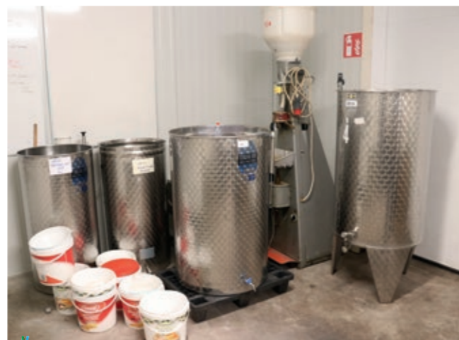
Foto. Gistingsvaten en bottelmachine van Wijngaard 't Biezenhof. Foto Arnout Zwaenepoel.
