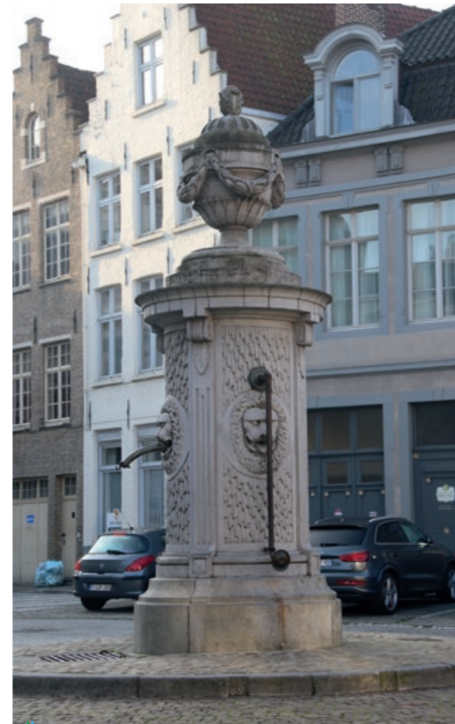
Foto. De waterpomp op het Sint-Jansplein werd gebouwd in 1786. Het is een classicistische armpomp, versierd met medaillons met een leeuwenkop, een siervaas, guirlandes en een vruchtenkorf. Een bronzen pomptuit ontspringt uit de muil van een leeuw. Aan de achterzijde bevindt zich een ijzeren pomparm. De pomp bleef in gebruik tot 1943 en is een beschermd monument sinds 2002. Foto Arnout Zwaenepoel.
